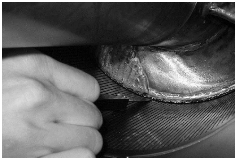
Fig. 13-14 : Mesure de l'écartement de travail entre tamis et vis sans fin ; la mesure est effectuée sur le dessous du tamis à l'arrêt de la machine. La mesure indique le double de l'écartement de travail car le tamis à l'arrêt repose sur le haut de la vis sans fin.
