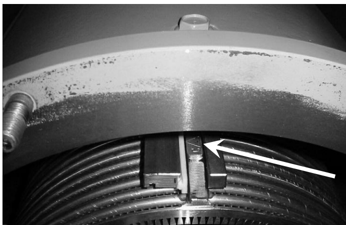
Fig. 13-9 Position de montage du tamis, triangle gravé vers le haut et vers l'avant en direction du séparateur
